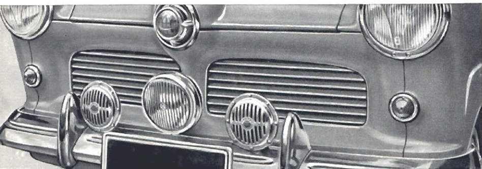
Anordnung zweier Hörner an der Wagenvorderseite
