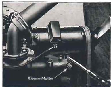
Die Regulierung d. Ventilatorriemens
